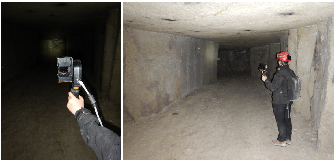
Figure 2 : Mise en œuvre du laser scanner 3D mobile Zeb Revo
