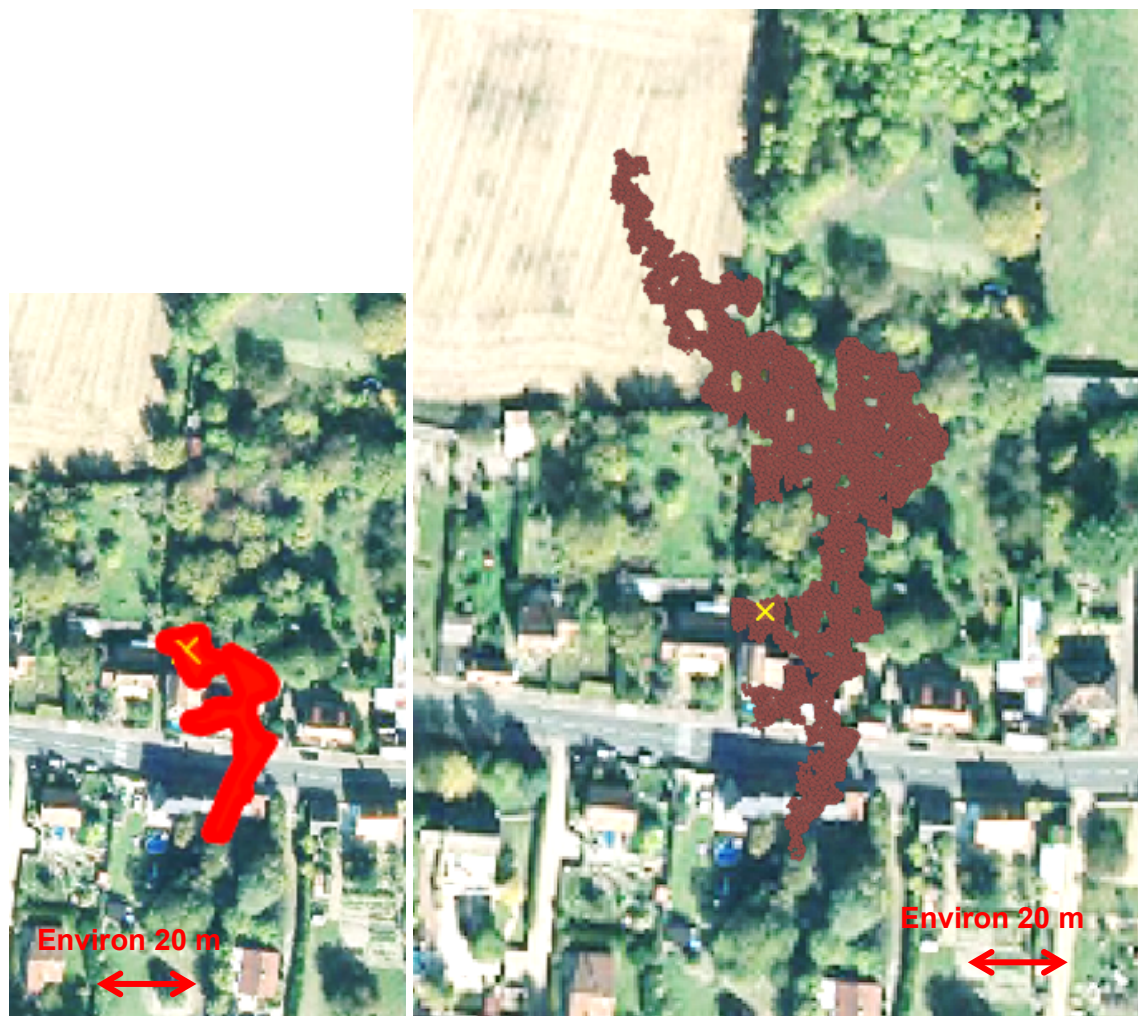
Figure 3 : Emprise de la cavité du Grenadier français (à gauche : levé de 2016 par ELC ,à droite : levé de 2020 par l'Ineris)
